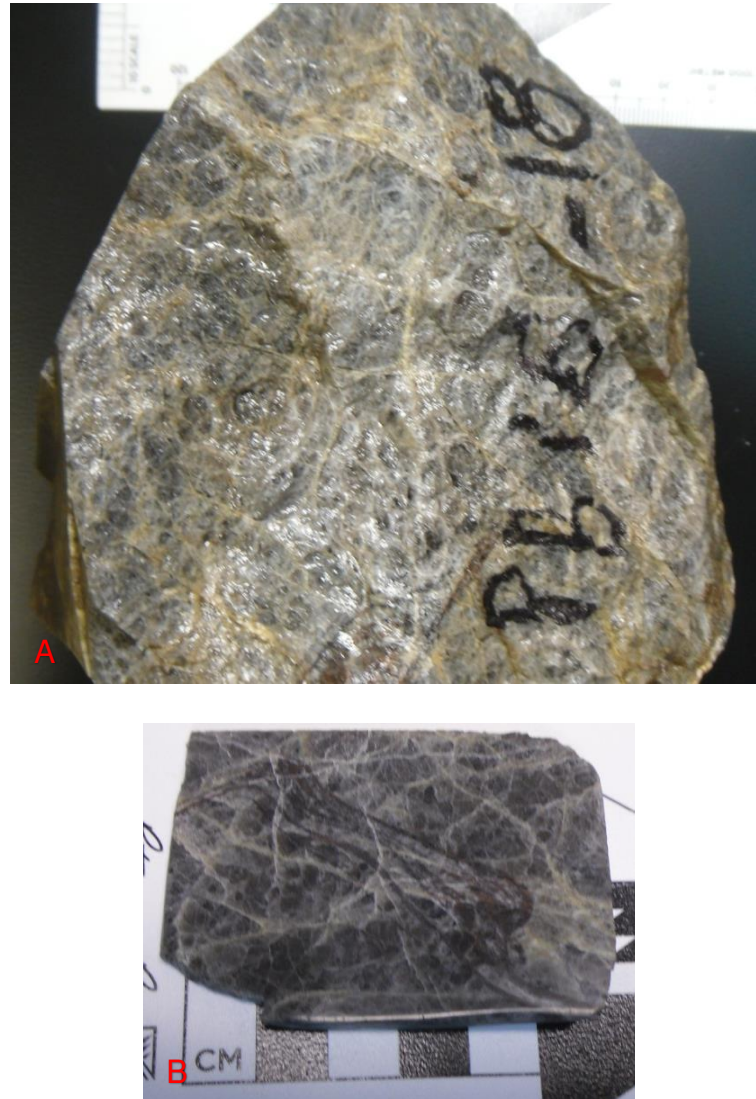
Fotografía 13. En la muestra de mano (A) PB16-18 se observa una matriz vítrea con lustre brillante, se aprecia un buen desarrollo de la textura perlítica. En el testigo (B) se aprecian laminaciones opacas contorsionadas.
