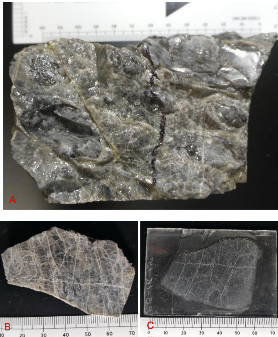
Fotografía 12. En la muestra de mano (A) PB16-15 se observa una matriz vítrea con lustre brillante, en el testigo (B) se observa un fracturamiento con dirección preferencial, y en sección delgada (C) se observa el desarrollo de una textura perlítica.
