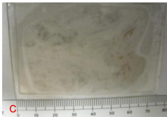
Fotografía 7. En la muestra de mano (A) PB16-C1 se presenta una matriz vitrea con textura fluidal, en el testigo (B) se observan laminaciones contorsionadas, en sección delgada (C) se observan laminaciones formadas por minerales opacos.
