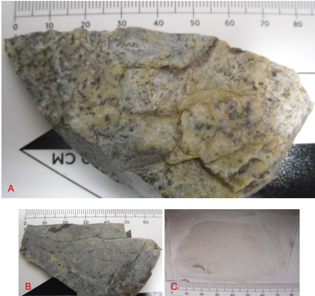
Fotografía 11. En la muestra de mano (A) PB16-C6B se observa una matriz vítrea con lustre opaco, en testigo (B) se observan minerales oxidados, y en sección delgada (C) se observa un ligero desarrollo de la textura perlítica.
